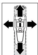
Placera mätverktyget på den yta som ska undersökas och förskjut det i sidled. När mätverktyget närmar sig metallobjektet ökar utslaget i mätvärdesstapeln **f**, avlägsnas det från objektet minskar utslaget. Vid positionen med största utslaget befinner sig metallobjektet under sensorns mitt (under markeringsöppningen **2**). Så länge mätverktyget befinner sig över metallobjektet lyser ringen **1** med rött ljus och en permanent signal avges.
