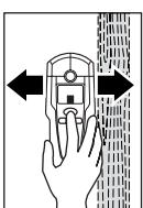
Bevæg måleværktøjet med nedtrykket taste „**ZOOM**“ **4** jævnth over undergrunden, uden at det løftes væk og uden at trykket ændres. Under målearbejdet skal filtgliederne **8** altid have kontakt med undergrunden.
