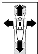
Položte merací prístroj na prehliadanú plochu a pohybujte ním bočne. Ked' sa merací prístroj priblíži ku kovovému objektu, výchylka indikácie merania f sa zväčší, ked' sa merací prístroj od objektu vzdialí, výchylka indikácie merania sa zmenší. V mieste maximálnej výchylky sa nachádza kovový objekt pod stredom senzoru (pod značkovacím otvorm 2). Kým sa merací prístroj nachádza nad kovovým objektom, svietiaci kružok svieti 1 červeno a súčasne zaznieva trvalý zvukový signál.
