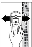
Turot nospiestu precīzas meklēšanas taustiņu „**ZOOM** **4**“, vienmērīgi pārvietojet mērinstrumentu pa seguma virsmu, to nepaceļot un nemainot spiedienu. Mērišanas laikā filca sīdvirsmām **8** nepārtrauktī jāsaskaras ar seguma materiāla virsmu.
