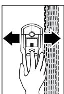
Pomicite mjerni alat sa pritisnutom tipkom „**ZOOM**“ **4** jednolično preko podlage, bez podizanja ili promjene pritiska. Tijekom mjerjenja klizač od filca **8** treba biti uvijek u kontaktu s podlogom.
