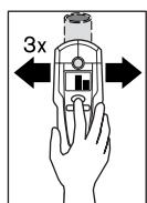
A fémtárgy helyzetének pontos meghatározásához nyomja meg és tartsa benyomva a „**ZOOM**” **4** billentyűt, és eközben ismét mozgassa el (3-szor) a mérőműszert a tárgy felett. A kijelzőn megjelenik a **e** Zoom-funkció kijelzése. A **e** Zoom-mérőkijelző kijelzése a fémtárgy közepe felett a legnagyobb.
