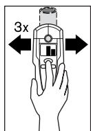
物体の正確な位置を測定する際には『ZOOM モード』ボタン 4 を押したままにし、物体上でメジャーリングツールを繰り返し移動させてください。ディスプレイ上に『ZOOM モード』サイン d が表示されます。メジャーリングツールが金属の中央に達すると、『ZOOM モード』探知インジケーター e のバー表示は最大となります。
