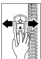
Spostare uniformemente sulla base di lavorazione lo strumento di misurazione tenendo sempre premuto il tasto «**ZOOM**» **4** senza sollevarlo e senza neppure modificare la pressione esercitata. Durante la misurazione è necessario che la slitta di guida in feltro **8** abbia sempre contatto con la superficie.
