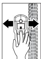
Равномерно перемещайте измерительный инструмент с нажатой клавишей «**ZOOM** 4 по всей площади, не отрывая его от поверхности и не изменяя усилия прижатия. Во время измерения фетровые подкладки **8** должны постоянно привлекать к поверхности.
