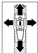
把探测仪放在探测表面上并左右移动仪器。当仪器渐渐靠近金属物体时，显示尺 **f** 上的显示刻度会逐渐上升。在仪器慢慢远离物体时，显示刻度又会慢慢下降。当显示刻度爬升到最高点时，代表金属物体正位在探测器的中央（即记号孔 **2**）的下方。如果不移动探测仪，光圈 **1** 会发出红灯并且仪器中会传出持续声响。
