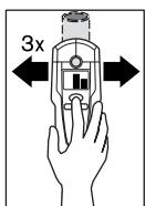
Para localizar exactamente el objeto, pulse la tecla “**ZOOM**” **4** y manténgala pulsada hasta haber pasado 3 veces con el aparato de medición por encima del objeto. En el display aparece el indicador de la función zoom **d**. En la posición correspondiente al centro del objeto metálico se obtiene la deflexión máxima en el indicador de medida zoom **e**.
