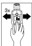
By dokładniej sprecyzować położenie obiektu należy wcisnąć przycisk „**ZOOM**“ 4 i przytrzymać go w tej pozycji, trzykrotnie (3x) przesuwając urządzenie pomiarowe ponad obiektem. Na wyświetlaczu ukaże się wskaźnik funkcji Zoom **d**. W środku obiektu metalowego wskaźnik pomiaru Zoom **e** wykazuje największe wychylenie.
