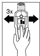
Lai precīzi uzmeklētu objektus, nospiediet precīzās meklēšanas taustiņu „**ZOOM**“ **4** un turiet to nospiestu, vienlaikus vairākkārt (3x) pārvietojot mērinstrumentu vīrs objekta. Uz displeja parādās precīzās meklēšanas funkcijas „Zoom“ indikators **d**. Brīdī, kad mērinstruments atrodas vīrs objekta vidus, precīzās meklēšanas „Zoom“ līmeņa indikatora **e** rādījumi sasniedz maksimālo vērtību.
