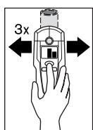
Pro přesnou lokalizaci objektu stlačte tlačítko „**ZOOM**“ **4** a podržte jej stlačené, zatímco opakováně (3x) pohybujete měřícím přístrojem přes objekt. Na displeji se objeví ukazatel funkce zoom **d**. Nad středem kovového objektu má ukazatel měření zoom **e** největší výchylku.
