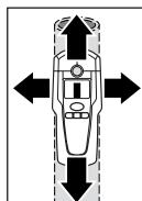
Приставте вимірювальний прилад до досліджуваної поверхні і починайте пересувати його убік. При наближенні вимірювального приладу до металу стовбчик штрихового індикатора f зростає, при віддаленні від металу балка зменшується. Максимальна висота стовбчика свідчить про те, що метал знаходиться під серединою сенсора (під отвором для нанесення позначок 2). До тих пір, поки вимірювальний прилад буде знаходитися над металом, світляне кільце 1 світиться червоним кольором і лунає безперервний сигнал.
