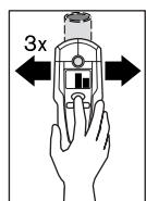
Za tačno određivanje objekta pritisnite taster „**ZOOM**“ **4** i držite ga pritisnut, dok merni alat pokreće ponavljajući 3x preko objekta. Na displeju se pojavljuje pokazivač Zoom-funkcije **d**. Preko sredine metalnog objekta ima Zoom-merni pokazivač **e** najveći otklon.
