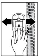
Movimentar o instrumento de medição uniformemente sobre o substrato, com a tecla “**ZOOM**” **4** premida, sem levantá-lo nem alterar a força de pressão. Durante a medição é necessário que o fletro de deslize **8** tenha sempre contacto com o substrato.
