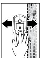
Mantenga pulsada la tecla “**ZOOM**” **4** y desplace uniformemente sobre el material de base el aparato de medida, sin separarlo y sin variar la presión de aplicación. Durante la medición deberán mantenerse siempre los fieltros de protección **8** en contacto con el material de base.
