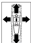
Tarama cihazını arama yapmak istediğiniz yüzeye yerleştirin ve yana doğru hareket ettirin. Tarama cihazı bir metal nesneye yaklaşınca ölçme göstergesindeki **f** sapma artar, uzaklaşınca sapma azalır. Göstergenin maksimum sapma pozisyonunda metal nesne sensör merkezinin altında bulunur (İşaret delğinin **2** altında). Tarama cihazı metal nesnenin üzerinde durduğu sürece halka **1** kırmızı yanar ve sürekli bir ses duyulur.
