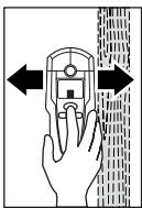
Bewegen Sie das Messwerkzeug mit gedrückter Taste „**ZOOM**“ **4** gleichmäßig über den Untergrund, ohne es abzuheben oder den Anpressdruck zu verändern. Während der Messung müssen die Filzgleiter **8** immer Kontakt zum Untergrund haben.
