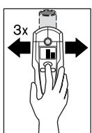
Для точной локализации объекта нажмите клавишу «**ZOOM** 4 и держите ее нажатой, пока Вы повторно (3 раза) передвигаете измерительный инструмент над объектом. На дисплее показывается функция Zoom **d**. Над серединой металлического объекта значение индикатора Zoom **e** имеет наибольшую величину.
