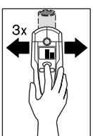
Για να εντοπίσετε το αντικείμενο με ακρίβεια πατήστε και κρατήστε πατημένο το πλήκτρο «**ZOOM**» 4, και στη συνέχεια μετακινήστε το εργαλείο μέτρησης επανειλημμένα (3 φορές) πάνω από το αντικείμενο. Στην οθόνη εμφανίζεται η ένδειξη λειτουργίας Zoom d. Η ένδειξη μέτρησης Zoom έχει τη μεγαλύτερη απόκλιση πάνω από το κέντρο που μεταλλικού αντικειμένου e.
