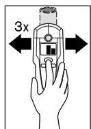
Za točno lociranje predmeta pritisnite tipku „**ZOOM**“ **4** i držite je pritisnutu dok mjerni alat ponavljano (3x) pomičete po predmetu. Na displeju će se pojavitи pokazivanje Zoom funkcije **d**. Iznad sredine metalnog predmeta, Zoom mjerni pokazivač **e** ima najveći otklon.
