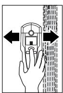
メジャーリングツールの『ZOOM モード』ボタン **4** を押したまま、探知面上を一定の速さで移動させてください。この際、メジャーリングツールを表面から離さないようにしてください。探知中は各フェルト部 **8** が探知表面に常時接触しているようにしてください。
