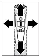
メジャーリングツールを探知したい表面にあて、横向きに移動させてください。メジャーリングツールが金属に近づくと、探知インジケーター f 上の表示バーが増し、金属から遠ざかると表示バーが減少します。金属がセンサー部の中央（マーキング用開口部 2 の下部）に達すると、表示バーが最大となります。メジャーリングツールが金属上に位置している間は、ライトリング 1 が赤色に点灯し、継続的に信号音が鳴ります。
