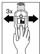
Paina kohteen tarkkaa paikannusta varten painiketta "**ZOOM**" **4** ja pidä se painettuna, kun mittautstyökalu toistuvasti (3x) liikkuu kohteen yli. Näytöön ilmestyy Zoom-toiminnon näyttö **d**. Metallikohde keskipisteen kohdalla on Zoom-mittausnäyttö **e** suurimmillaan.
