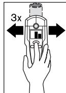
Pour une localisation précise de l'objet, appuyer sur la touche « **ZOOM** » **4** et la maintenir appuyée tout en déplaçant l'appareil de mesure plusieurs fois (3 fois) sur l'objet. La fonction Zoom **d** est affichée. L'oscillation de l'affichage de mesure Zoom **e** est à son maximum sur le centre de l'objet en métal.
