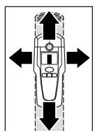
Stavite mjerni alat na ispitivanu površinu i pomaknite ga bočno. Kako se mjerni alat približava metalnom predmetu, povećava se otklon mjernog pokazivača **f**, a sa odmicanjem mjernog alata od metalnog predmeta, ovaј se otklon smanjuje. Na određenoj poziciji maksimalnog otklona nalazi se metalni objekt ispod sredine senzora (ispod otvora za označavanje **2**). Sve dok se mjerni alat nalazi iznad metalnog predmeta, svijetli crveni prsten **1** i oglašava se stalni zvučni signal.
