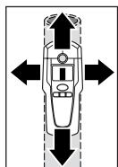
Nasadte měřící přístroj na prohledávaný povrch a pohybujete jím na stranu. Přibližuje-li se měřící přístroj ke kovovému objektu, pak přibývá výchylka u ukazateli měření **f**, oddaluje-li se od objektu, pak výchylka ubývá, na místě maximální výchylky se nachází kovový objekt pod středem čidla (pod značkovacím otvorem **2**). Dokud se měřící přístroj nachází nad kovovým objektem, svítí kroužek **1** červeně a ozývá se trvalý tón.
