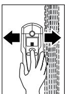
Pokrećite merni pribor sa pritisnutom dirkom „**ZOOM**“ **4** ravnometno iznad podloge, bez podizanja ili menjanja pritiska. Za vreme merenja moraju filcani klizači **8** imati uvek kontakt sa podlogom.
