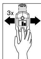
Drücken Sie für eine genaue Lokalisierung des Objektes die Taste „**ZOOM**“ **4** und halten Sie sie gedrückt, während Sie das Messwerkzeug wiederholt (3x) über das Objekt bewegen. Im Display erscheint die Anzeige der Zoom-Funktion **d**. Über der Mitte des Metallobjektes hat die Zoom-Messanzeige **e** den größten Ausschlag.
