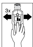
按下 "ZOOM" 按钮 **4** 能够更精确地显示隐藏物体的位置。先按住按钮，紧接着在发现物体的上方来回移动探测仪（3次）。此时显示屏上会出现放大功能的图案 **d**。当放大功能显示尺 **e** 的测量结果达到最高点时，则代表探测仪位在金属物体的正上方。
