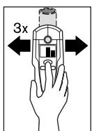
Para uma localização exacta do objecto, deverá premir a “**ZOOM**” **4** e mantê-la premida enquanto movimentar repetidamente (3x) o instrumento de medição novamente sobre o objecto. No display aparece a indicação da função zoom **d**. A indicação de medição zoom **e** tem a maior amplitude sobre o centro do objecto metálico.
