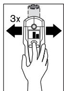
Als u het voorwerp nauwkeurig wilt lokaliseren, drukt u op de toets „**ZOOM**“ **4** en houdt u deze toets ingedrukt terwijl u het meetgereedschap meerdmaals (3x) over het voorwerp beweegt. In het display wordt de indicatie van de zoomfunctie **d** weergegeven. Boven het midden van het metalen voorwerp heeft de zoommeetindicatie **e** de grootste uitslag.
