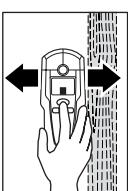
Förskjut mätverktyget med nedtryckt knapp **"ZOOM"** 4 jämnt över undergrunden utan att lyfta upp mätverktyget eller öka trycket mot ytan. Under mätningen ska filtglidstyckena 8 ligga mot undergrunden.
