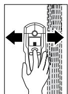
Пересуваєте вимірювальний прилад з натиснутою кнопкою «**ZOOM** 4 i рівномірно по поверхні, не підіймаючи його і не змінюючи силу натискування. Під час вимірювання повстяні підкладки **8** завжди повинні мати контакт з поверхнею.
