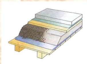
podsypaní plovoucí betonové podlahy na trámovém stropě s vložkou proti kročejovému zvuku
